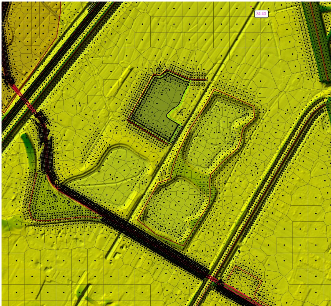
Figura 9. Particolare degli elementi Breakline in corrispondenza di argini e tracciato della tramvia
